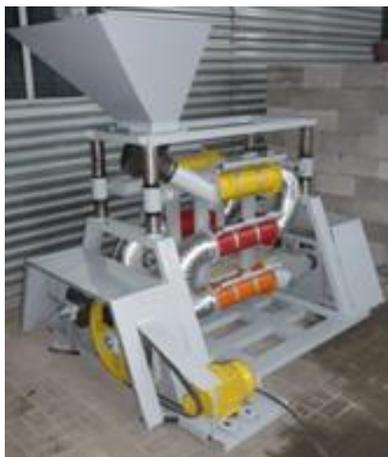
Конструкция данного агрегата позволяет обеспечить самоуравновешивание помольных блоков, что приводит к снижению удельных энергозатрат на 35-40%.
