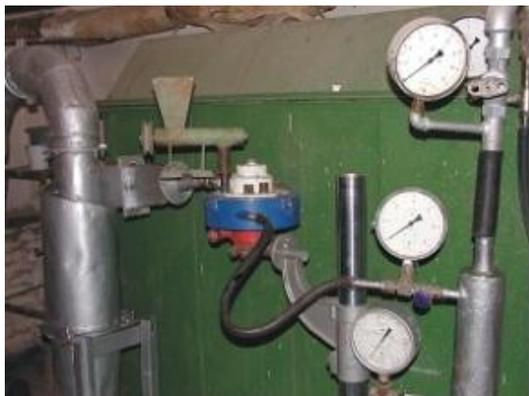
природные пигменты, трепел, опоки и др.). Давление сжатого воздуха  $P = 3-6$  атм. Скорость потока  $V = 50-250$  м/с; диапазон вихревых акустических частот: инфразвуковых  $\leq 100$  Гц, ультразвуковых  $\geq 18-20$  кГц. Размер тонкоизмельченных частиц  $d_{\text{ср.взв.}} \leq 5-10$  мкм.
