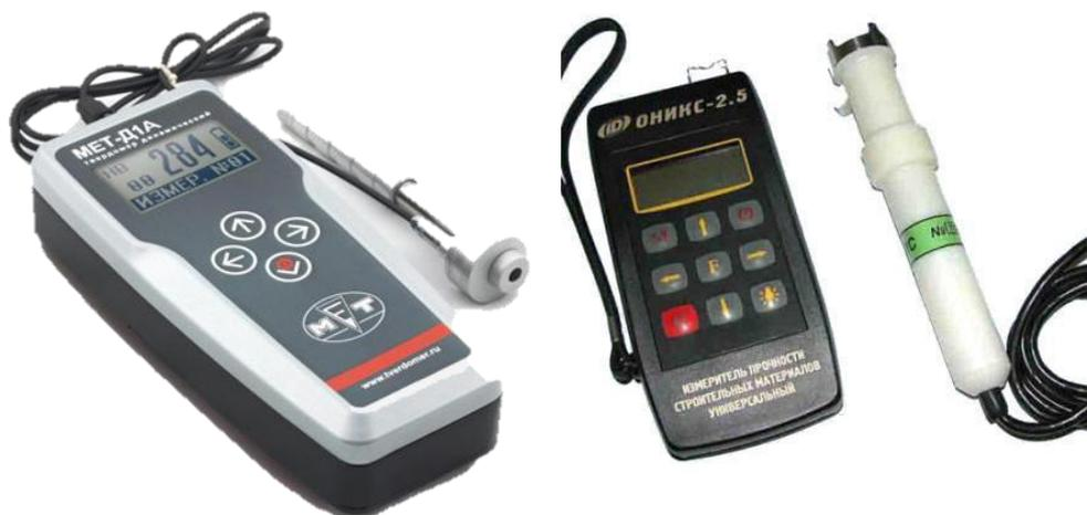
Прибор позволяет измерять показатель твердости стали, по которому рассчитывается показатель прочности.
