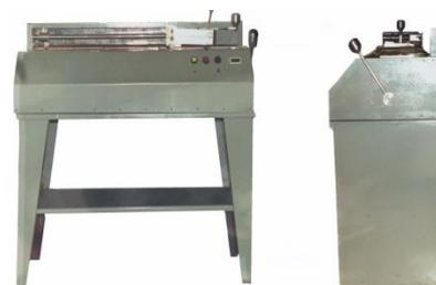
Изготовлена опытная установка, проведены испытания, планируется внедрение разработки для нанесения маркировки на пластмассовые изоляции на проводах.
