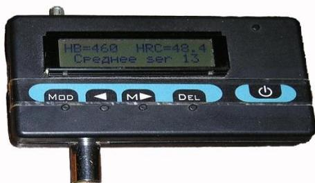
Прибор объединяет в одном корпусе ударное устройство и процессор обработки данных. При этом не используются разъемы и соединительные провода. Это позволяет ему сочетать преимущества компактного размера, удобства в переноске и простоты в использовании, с высокой надежностью и широким диапазоном измерения.
