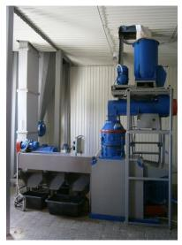
Обеспечивается получением качественных гранул с различными физико-механическими характеристиками при постадийном высокоскоростном смешении поликомпонентной шихты, ее предуплотнении и экструдировании с организацией рециклинга тепловых потоков и утилизации просыпи гранул.
