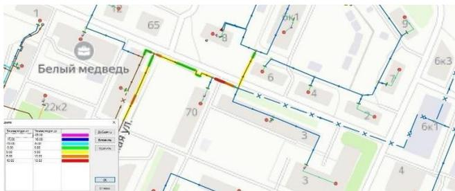
Рис. 1 – Снимок экрана цветового обозначения трубопроводов в ГИС-системе ZuluGIS
