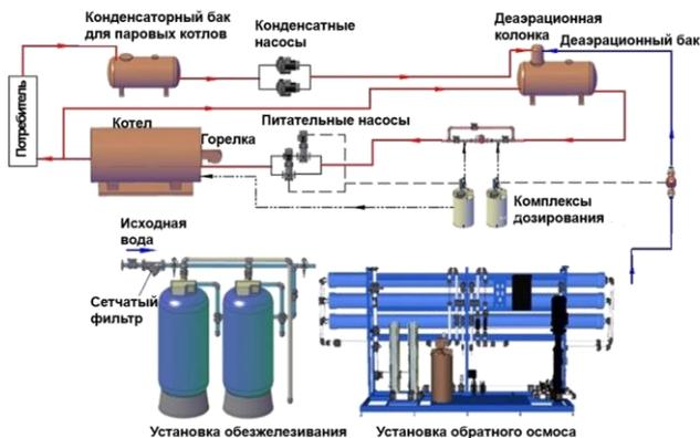
Рис. 2 Комбинированная схема водоподготовки
