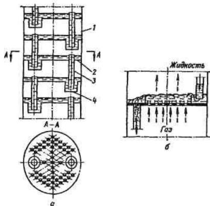
Рис. 11.2. Принцип работы ситчатого абсорбера:
