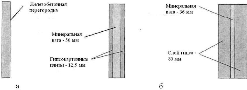
Рис. 5.1. Примеры звукоизолирующих конструкций: а) однослойная; б) многослойная
