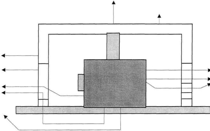
Рис. 6.1. Возможные пути передачи звука через кожух машины
