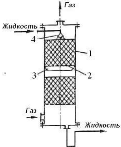
Рис. 11.1. Принципиальная схема насадочного абсорбера:
