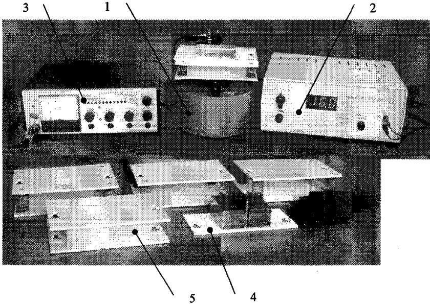
Рис. 8.1. Установка для измерения вибрации
