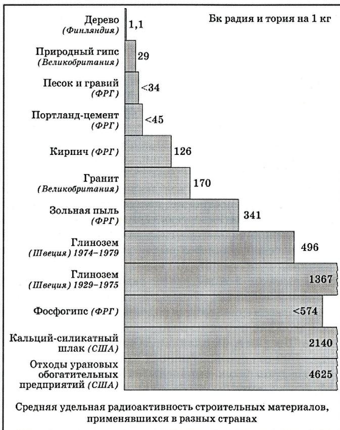
Рис. 1.4.3. Выделение радона различными строительными материалами
