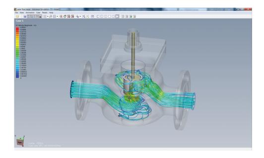
Autodesk Simulation CFD позволяет инженерам на этапе проектных работ улучшить гидравлические характеристики проектируемой конструкции, оптимизировать конструкцию трубопроводной арматуры, снизить потери давления и увеличить расход потока. Расчеты позволяют принять меры для предотвращения кавитации.
