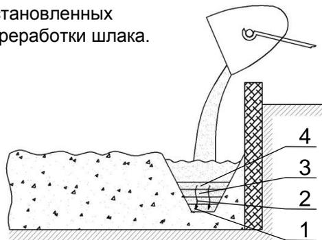
Рис. 2. Схема утилизации металлосодержащих отходов с использованием тепла шлакового расплава:
