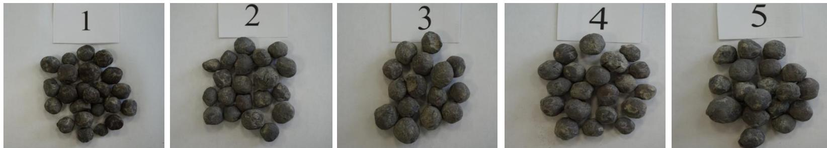
Железорудные окатыши после покрытия суспензиями:
