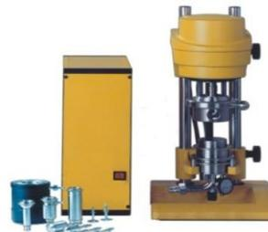
Прибор для измерения краевого угла
