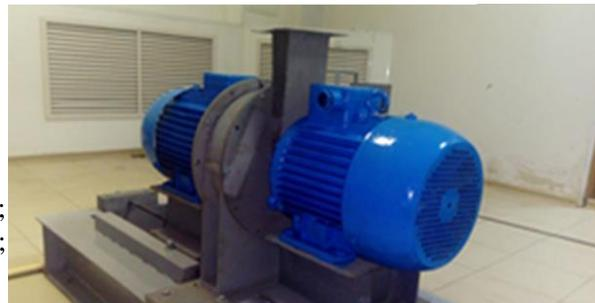
Дезинтегратор мощностью 7,5 кВт
