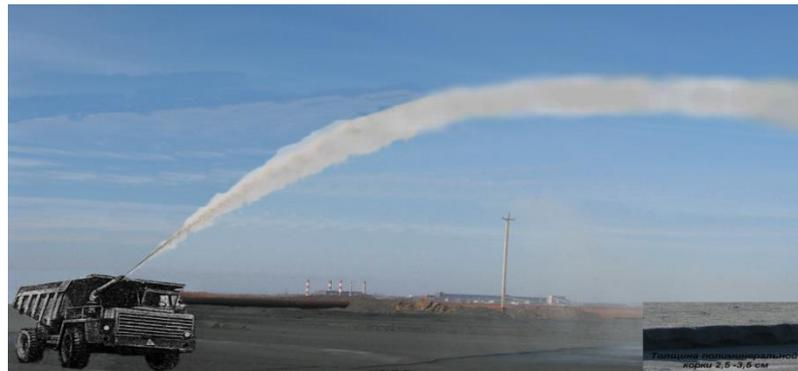
Закрепляющие растворы разработаны под различные условия производства для различных составов, дисперсности и пористости полиминеральных пылящих систем. Все компоненты состава экологически безопасны. Использование разработанного закрепляющего раствора при расходе 1,5-2,0 л/м<sup>2</sup> поверхности снижает загрязненность воздуха пылью в 15-17 раз. При этом запыленность воздуха при выходе из хвостохранилища не превышает 1,1 мг/м<sup>3</sup> при скорости ветра до 10 м/с.
