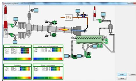
Система предназначена для сбора в режиме реального времени информации о состоянии объекта через существующую базу данных, оценки режимов функционирования и предложения оператору печи вариантов действий для наиболее эффективного управления. Части системы сданы в промышленную эксплуатацию на ЗАО «Осколцемент» и ОАО «Себряковцемент». С фирмой AdAst ra (производитель систем автоматизации, г.Москва) заключен договор о намерениях по внедрению предлагаемых алгоритмов в SCADA-систему Tr aceMde.
