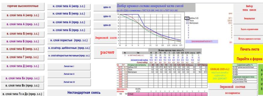
Программа позволяет значительно сэкономить время, затрачиваемое на процедуру подбора состава асфальтобетонных смесей, экономить средства, затрачиваемые на приобретение минеральных материалов, гарантирует соответствие гранулометрического состава асфальтобетона требованиям нормативных документов предъявляемых к зерновому составу.
