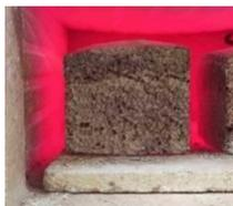
Рис. 5 Пенобетон на НВ после обжига
