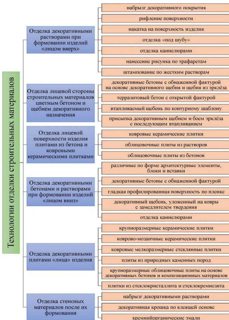
Рис. 1. Технологии отделки строительных материалов
