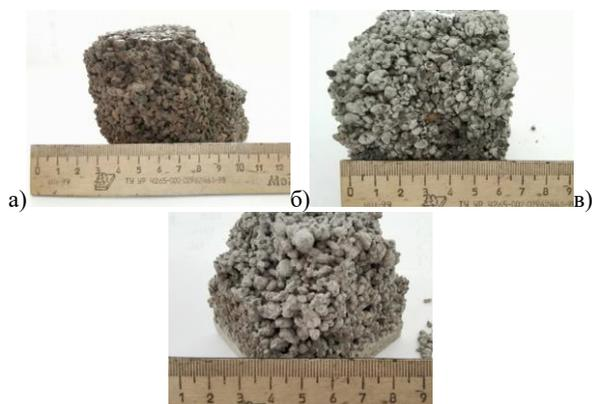
Рис.2 Структура оптимальных составов КПКБ для 3D-аддитивных технологий: а)№1; 2)№7; 3)№9
