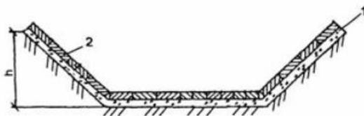
Рис. 1 Быстроток, укрепленный цементобетонными плитами:
