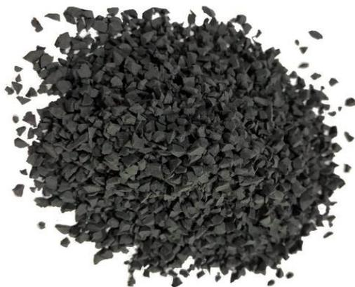
Рис. 3 Результат измельчения шин
