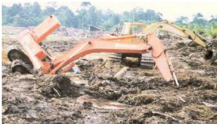
Рис. 3 Низкая несущая способность торфа
