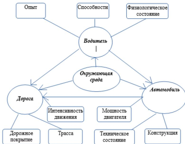
Рис. 1 Система «водитель-автомобиль-дорога-среда» (ВАДС)
