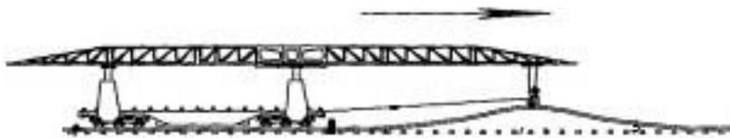
Рис. 1 Схема удлинения плетей бесстыкового пути
