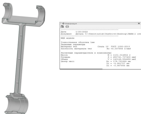
Рис. 3 Массово-центровочные характеристики пустотелой детали «рычаг» с толщиной стенки 1 мм
