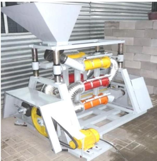
Рис. 2 Центробежный агрегат с параллельными помольными блоками
