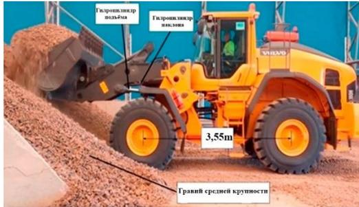
Рис.1 Колесный погрузчик Volvo L180H с оператором, заполняющим ковш гравием средней крупности
