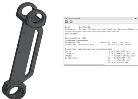
Рис. 2 Массово-центровочные характеристики детали «рычаг»
