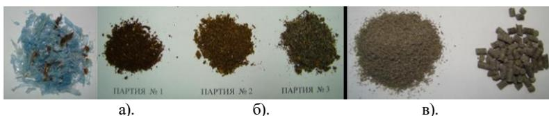
Рис. 1 Вторичное сырье из бытовых отходов: а) - измельченный вторичный полиэтилен; б) - обработанные пищевые отходы; в) - измельченные и гранулированные целлюлозно-бумажные отходы.
