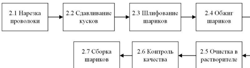
Рис. 2 Технологический процесс изготовления шариков
