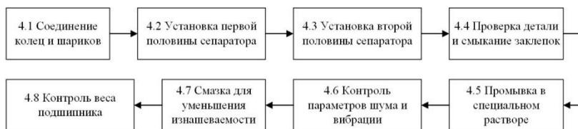
Рис. 4 Технологический процесс сборки подшипника
