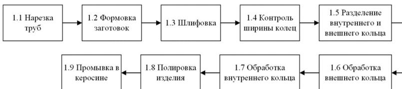
Рис. 1 Технологический процесс изготовления колец
