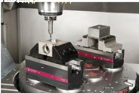
Рис. 5 Пример использования станочной оснастки изготовленной аддитивным методом
