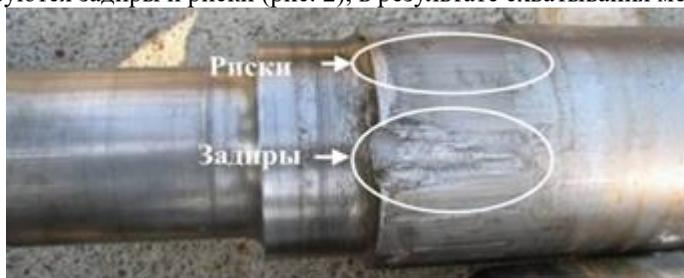
Рис. 2 Задиры и риски на подступичных частях оси [1]
