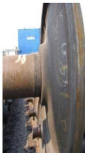
Рис. 1 Сдвиг колеса на оси [1]
