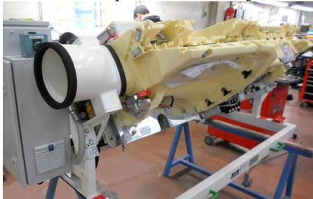
Рис. 4 Пример использования FDM печати для изготовления цеховой оснастки
