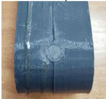
Рис. 6 Физическая модель армированного образца детали «Серьга»
