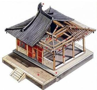
Рис.1. Каркасная конструкция
