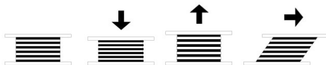
Рис.4 Принцип действия эластомерной опоры.
