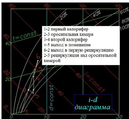
Рис. 3 – i-d диаграмма вентиляции с двумя рециркуляционными ходами
