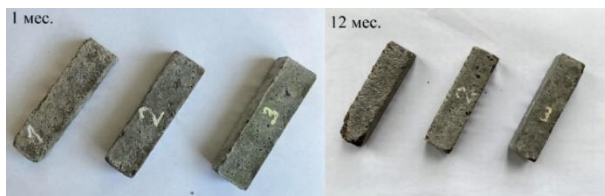
Рис. 2 – Внешний вид образцов, твердевших в 1,5-% р-ре MgSO_4 1 и 12 мес. Состав: 1– 1:9, 2–1:7, 3–1:5
