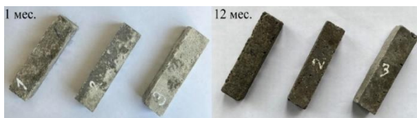
Рис. 3 – Внешний вид образцов, твердевших в 1,5-% р-ре Na_2SO_4 1 и 12 мес. Состав: 1– 1:9, 2–1:7, 3–1:5
