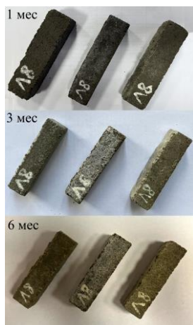
Рис. 1. – Внешний вид образцов, твердевших (слева направо) в водопроводной воде, в 1,5 %-м растворе MgSO_4 и в 1,5 %-м растворе Na_2SO_4 1, 3 и 6 мес.
