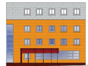
Рис. 2 – Пример надстройки этажа жилого здания с применением газобетонных строительных систем
