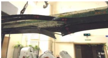
Рис. 3 – Характерный вид разрушения экспериментальной балки
