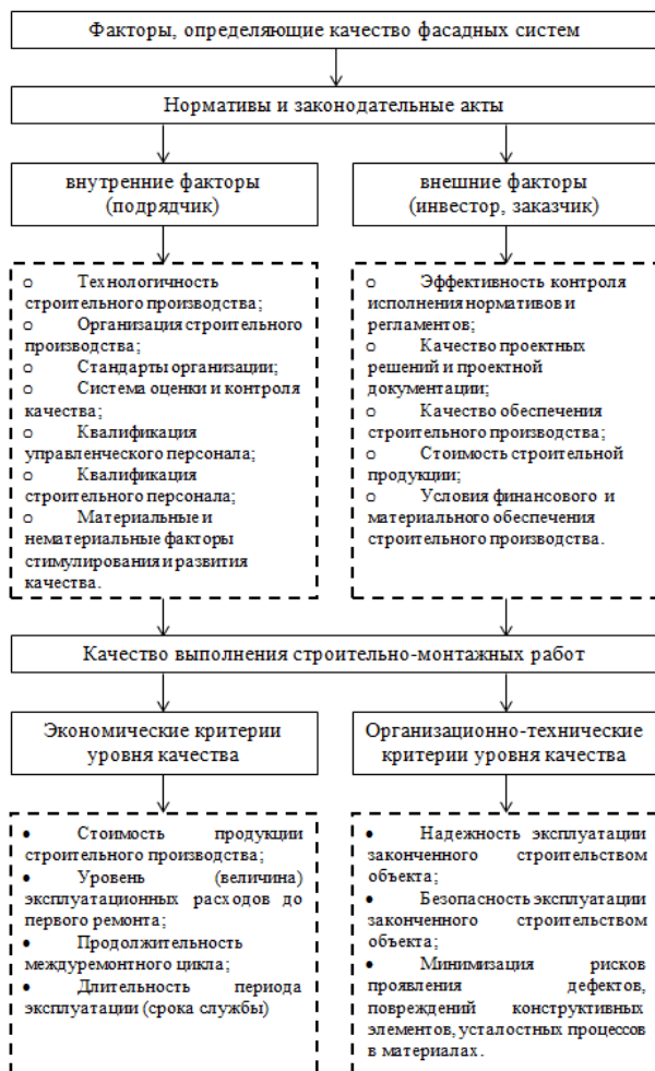
Рис. 3 – Структура формирования качества фасадных систем
