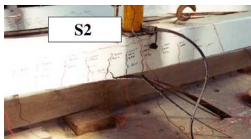
Рис. 1 – Испытание усиленных композитом железобетонных балок
