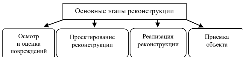
Рис.1 – Этапы реконструкции объектов после повреждений
