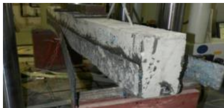
Рис. 2 – Испытание одной из конструктивных схем усиленных композитом железобетонных балок
