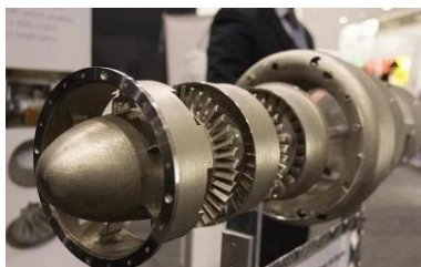
Рис. 3 – Реактивный двигатель, изготовленный с применением металлгибридного аддитивного производства.
