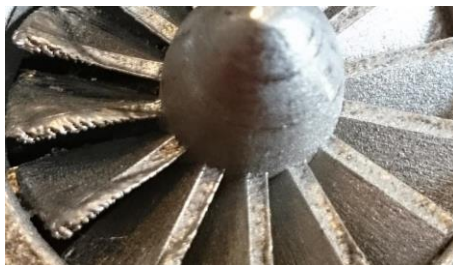
Рис. 1. – Дефект из-за недостаточного теплоотвода
