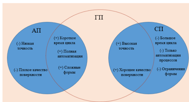
Рис. 2 – Гибридное производство (ГП): интеграция аддитивного (АП) и субтрактивного производства (СП).
