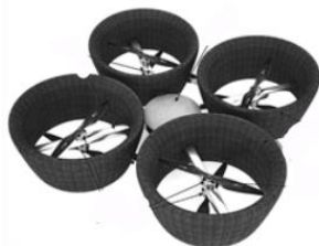
Рис. 1 – Беспилотный аппарат с аэродинамическим профилем колец
