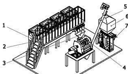
Рис. 3 – Технологический комплекс с партерной схемой фасовщика
