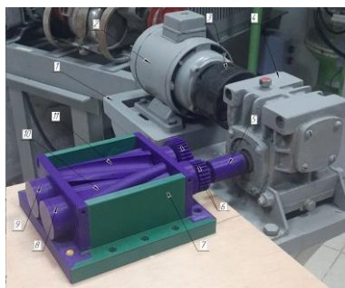
Рис. 1 – Модель измельчителя изготовленная на 3Д принтере: 1 – станина; 2 – электродвигатель; 3, 5 – муфта; 4 – редуктор; 6 – зубчатая передача; 7 – корпус; 8, 9 – подшипниковая опора; 10, 11 – валки
