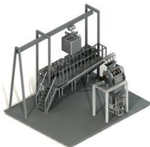
Рис. 1 – Технологический комплекс с вертикальной схемой фасовщика
