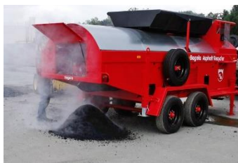
Рис.1 – Горячая регенерация асфальтобетона
