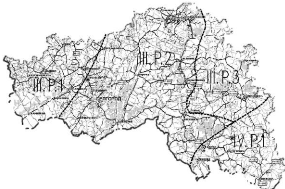
Рис.1 – Схема дорожно-климатического районирования территории Белгородской области: III, IV – дорожно-климатические зоны; P – подзона по типу рельефа (равнинный); 1-3 – номера дорожных районов
