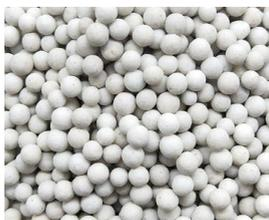
Рис. 1 – Инертные керамические шарики – носители катализаторов
