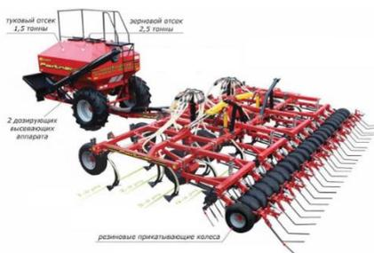
Рис. 1 – Дозирующий высеивающий аппарат
