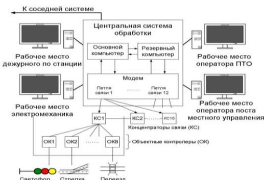
Рис. 1 – Структурная схема микропроцессорной централизации
