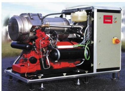
Рис. 4 – Промышленный двигатель Стирлинга
