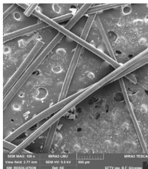
Рис. 1 – Микроструктура полипропиленовой фибры l = 6 мм
