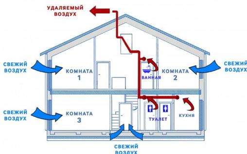
Рис. 1 Схема естественной вентиляции в жилых домах
