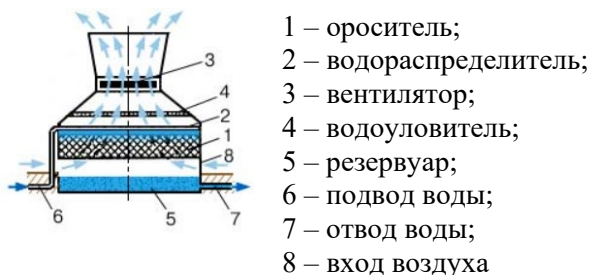
Рис. 3 Схема вентиляторной градирни
