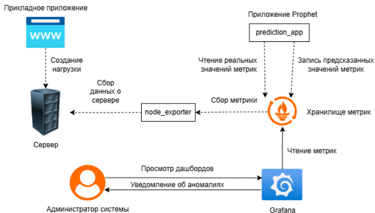
Рис. 1 Схема работы системы мониторинга с предсказанием будущих значений метрик
