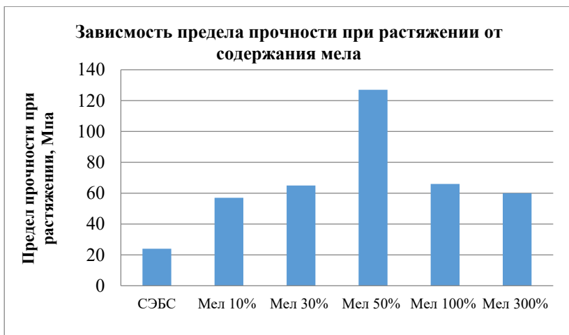
Рис. 3. Результаты испытаний образцов на предел прочности при растяжении
