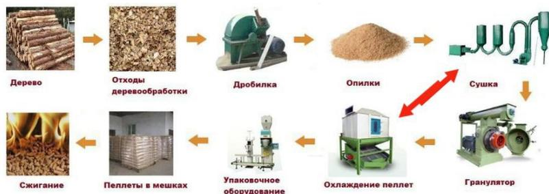
Рис. 2 Технологический процесс изготовления пеллет
