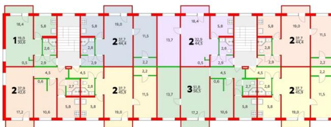
Рис.4. План этажа серии 1-464 (красным выделены несущие стены)
