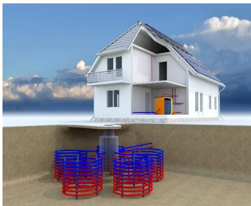
Рис.2. Геотермальный тепловой насос
