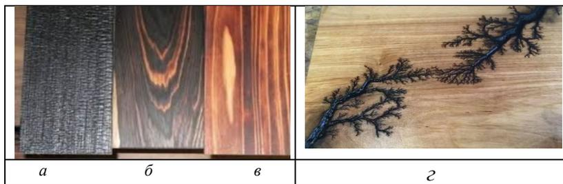
Рис. 3 Виды обжига по степени интенсивности воздействия огнем: *a* – глубокая обработка; *б* – обработка средней интенсивности; *в* – легкая обработка для подчеркивания текстуры древесины, *z* – молнии на древесине.
