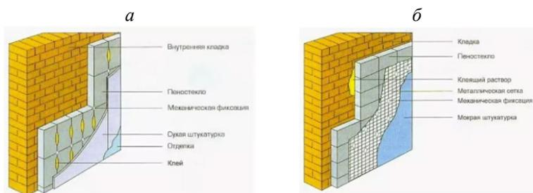
Рис. 2. Варианты конструктивно-технологических решений утепления наружных стен зданий с постоянным пребыванием людей:
