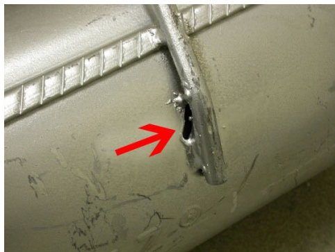
Рис. 3 – прожог сварного шва
