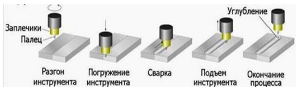
Рис 2. – Этапы процесса сварки трением с перемешиванием.
