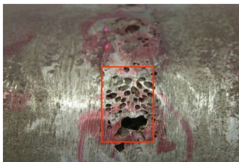
Рис. 4 – Поры и шлаковые включения
