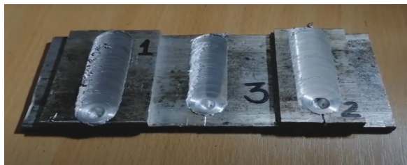
Рис 3. – Внешний вид шва, полученного СТП
