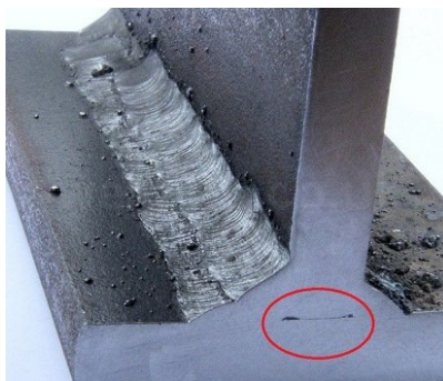
Рис. 2 – непровар корня шва
