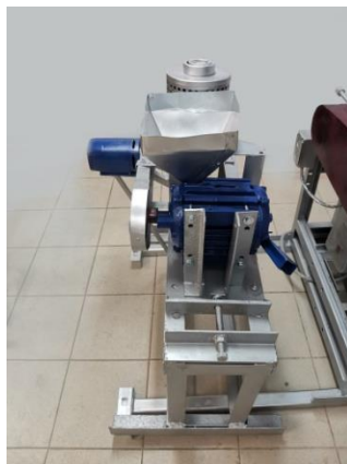
Рис. 2 Роторный агрегат с комплексным динамическим воздействием на сырье
