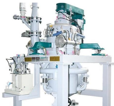
Рис. 3 Струйная мельница, предназначенная для помола керамики
