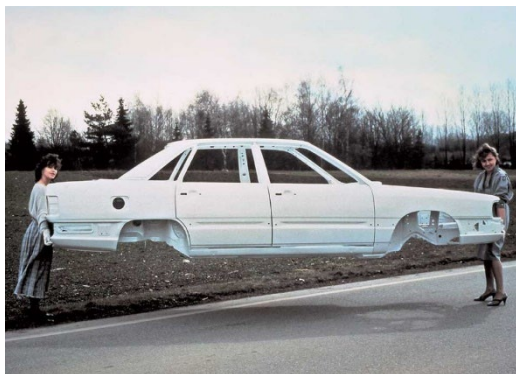
Рис. 1 Демонстрация легкости алюминиевого кузова прототипа Audi 100 в рекламе 80-х [3]
