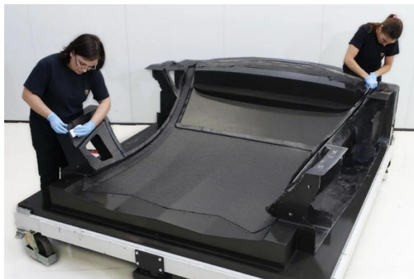
Рис. 2 Производство элемента кузова Lamborghini Aventador LP700-4 из композитных материалов [6]
