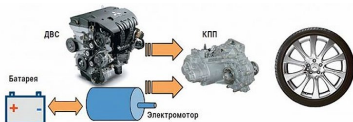
Рис. 3 Схема параллельного гибридного автомобиля
