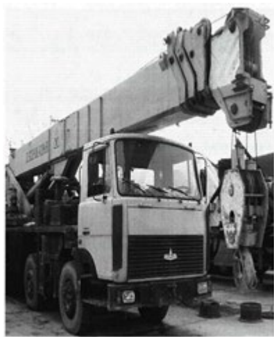
Рис. 1 Автомобильный кран КС-6476, рег. № 411116, зав. № 113, грузоподъемность 50 тонн
