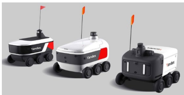
Рис. 1 Три поколения роботов-курьеров, R1, R2, R3
