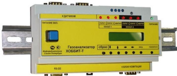
Рис. 2. Газоанализатор паров соляной кислоты
