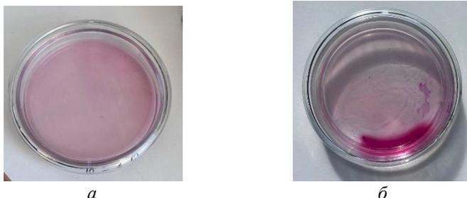
Рис. 1. Фотографии эксперимента по установлению в пробе природной воды наличия патогенных микроорганизмов с учетом разведения: *а* –  $10^{-3}$ , *б* –  $10^{-5}$
