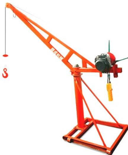
Рис. 3. Подъемный поворотный мини-кран
