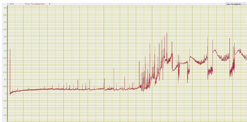
Рис. 6 График зависимости коэффициента трения от времени для покрытия а-С:Н:W+MoS 2
