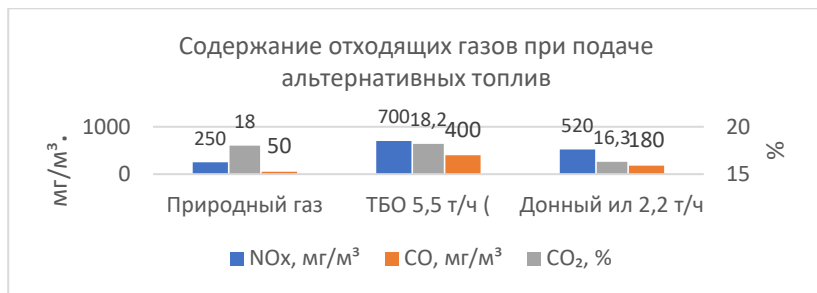
Рис. 2 Рисунок 3.3.1 Содержание отходящих газов при подаче альтернативных топлив
