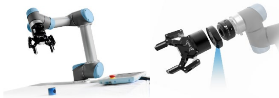
Рис. 4. Коллаборативный робот UR10e
