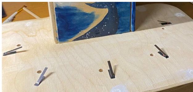
Рис. 3. Микровыключатели, вмонтированные в корпус устройства
