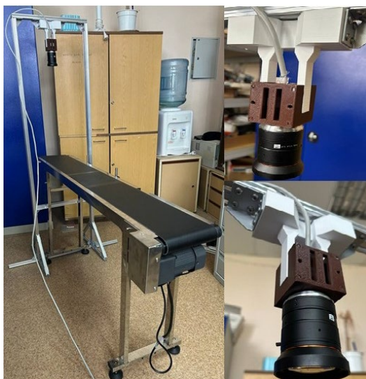
Рис. 2. Реализация учебного стенда с подключённой камерой
