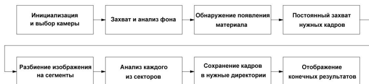
Рис. 3. Структура работы программной части
