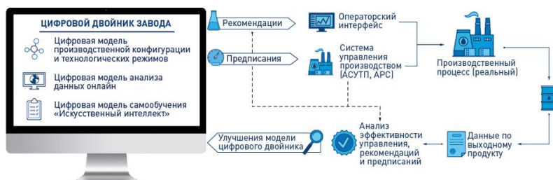
Рис. 5 Схема цифрового двойника
