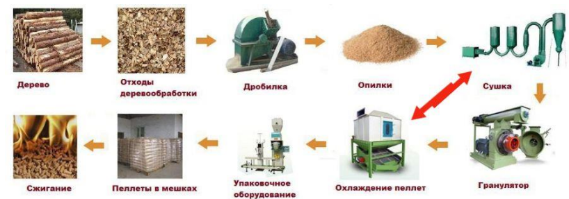
Рис. 2 Технологический процесс изготовления пеллет
