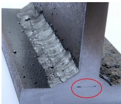
Рис. 2 – непровар корня шва
