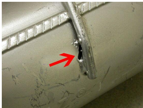
Рис. 3 – прожог сварного шва
