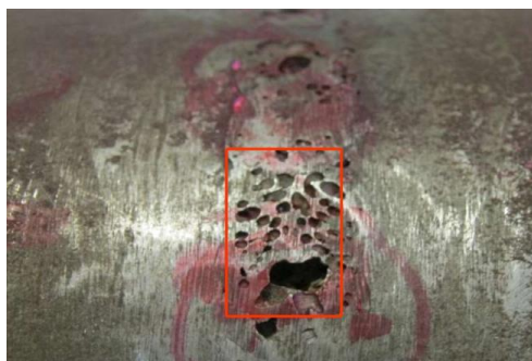
Рис. 4 – Поры и шлаковые включения
