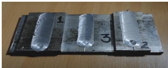
Рис 3. – Внешний вид шва, полученного СТП
