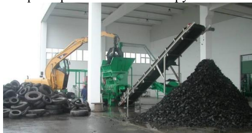
Рис. 1 Механический способ дробления шин
