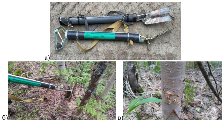
Рис. 1. Инъектор «Кобра»: а – вид общий, б - надрез ствола дерева, в – зарубка
