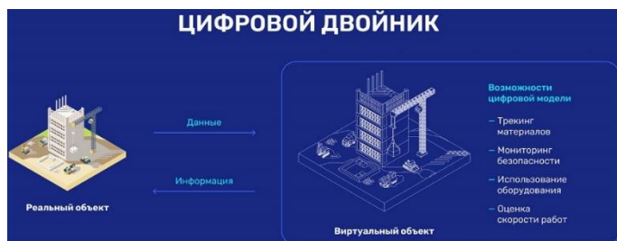
Рис. 3 Схема работы цифрового двойника на этапе эксплуатации объекта
