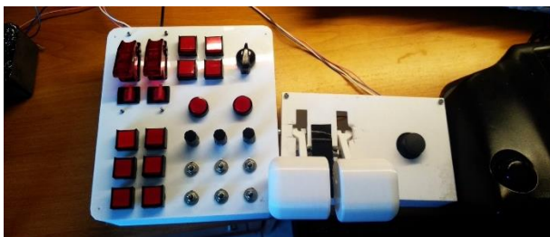
Рис. 5 Универсальная панель управления и ручка управления двигателем
